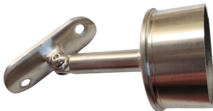
Linea: H004 Clave: SO-8020 T Acabados: SATIN Material: ACERO INOXIDABLE 304 SOPORTE PARA BARANDAL TUBO A PASAMANO TUBO DE 2 PULGADAS
